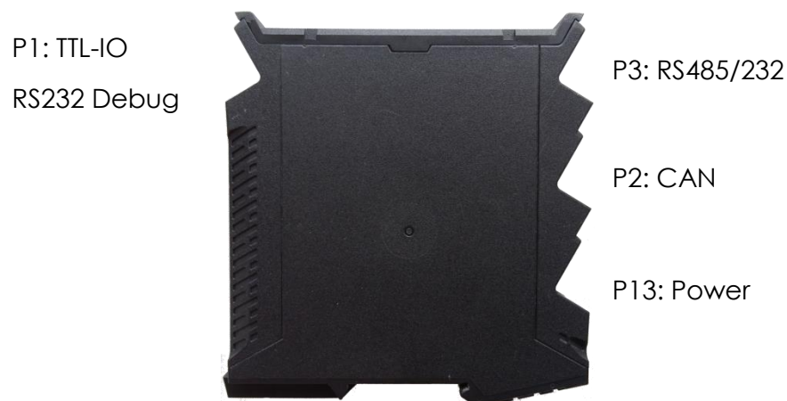
Abbildung 2: Reihenklemmen am piA-AM3505
