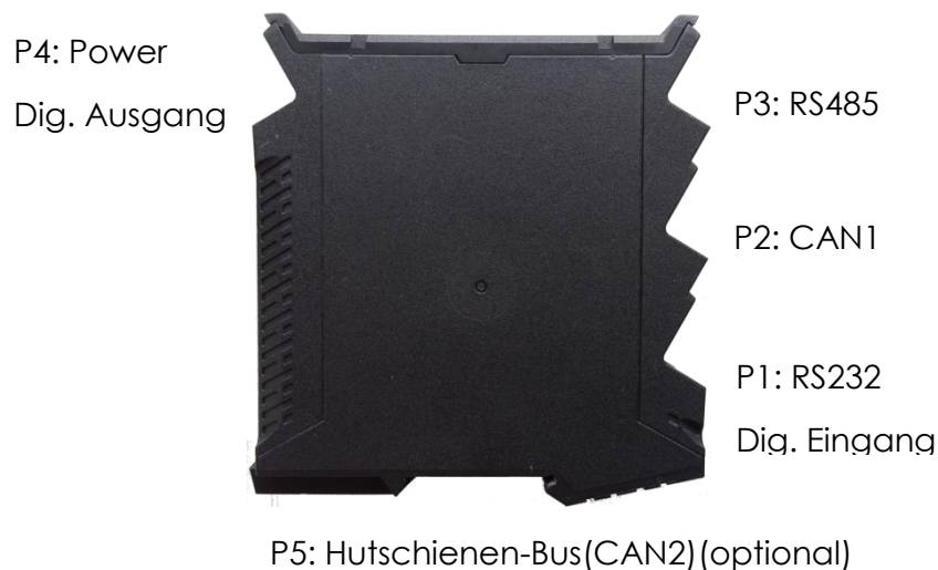
Abbildung 1: Reihenklemmen am piA-AM3352
